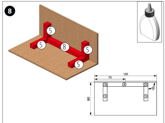
Die beiden MDF-Platten (11) im 90° Winkel zusammenleimen. Die Leiste (8) ausgemittelt einleimen und jeweils eine Holzleiste (5) an beiden Enden der Leiste (8) aufleimen. Siehe Abbildung!
