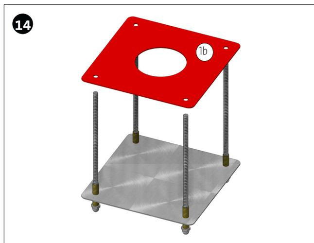
Poser le fond intermédiaire (1b) sur les bouts de tubes en laiton.
