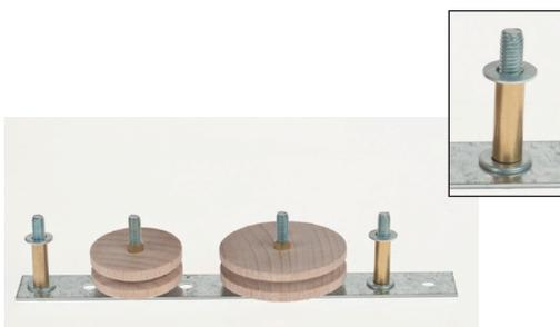
7. Piazzare la seconda striscia di lamiera allineata alla prima sulle viti, fissare le viti con un dado bloccante (7) tramite cacciavite e chiave inglese.
