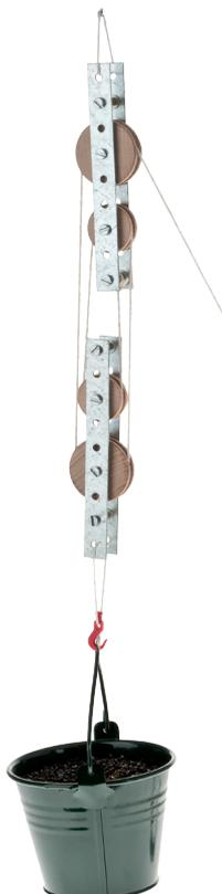
14. Der Seilzug kann nun vorsichtig aufgehängt werden. Sobald ein Gewicht an den Haken gehängt wird, läuft auch die Schnur stramm in den Rädern. Durch Zug an der langen Schnur können nun beliebige Gewichte nach oben und unten befördert werden.
