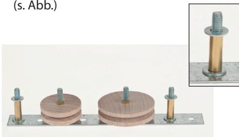
7. Zweites Lochblech deckungsgleich auf die Schrauben aufsetzen, jeweils eine Stopfmutter (7) mit Hilfe eines Schraubendrehers und Gabelschlüssels befestigen.
