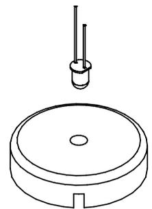
2. Riportare l'incavo per l'interruttore dopo la misurazione (vedi disegno) sul dado (1). Quindi forare a  $\varnothing 6$  mm. Eliminare con la lima per lavori di precisione la parte rettangolare di 12 x 6 mm.
