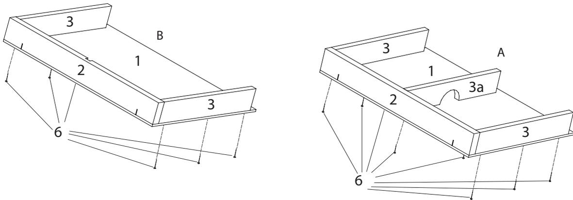
6. Die zweite Holzleiste (2) nach Abbildung mit der Aussparung nach innen und den Sägeschnitten nach unten bündig an die Holzleisten (3) auf die Grundplatte aufleimen. Leiste (2) von der Rückseite mit ca. 5 Nägeln fixieren. Leim gut trocknen lassen.
