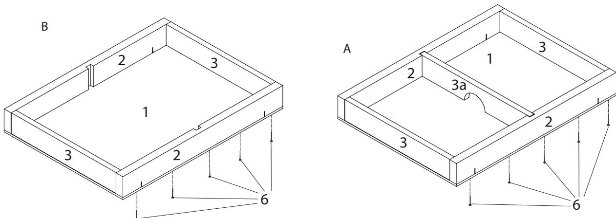
7. Die fertige Holzleiste (3a) wie abgebildet in die Aussparungen der Leisten (2) einstecken. (Variante 2)
