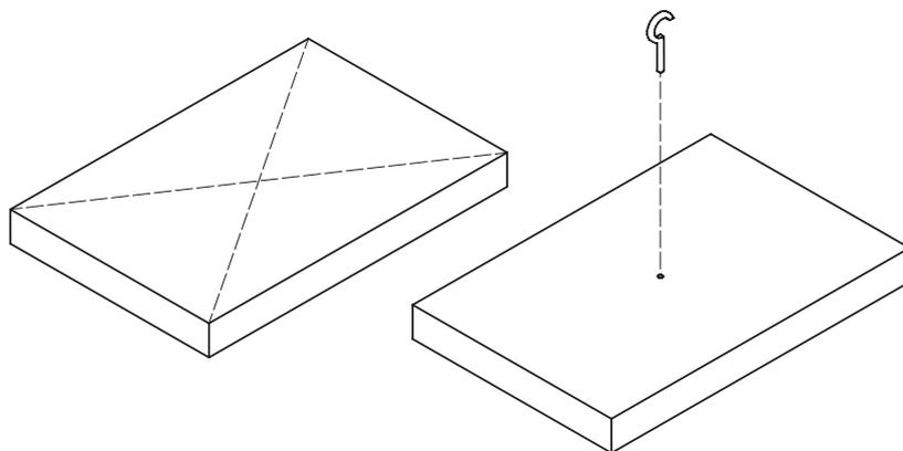
3. Die fertigen Blechteile (1b) wie abgebildet an den langen Seitenkanten des Leimholzes (1) mit jeweils 3 Schrauben (6) festschrauben. Darauf achten, dass die  $\varnothing 8$ mm-Bohrungen in Richtung Oberseite zeigen! Der Schraubhaken befindet sich an der Unterseite des Leimholzes.
