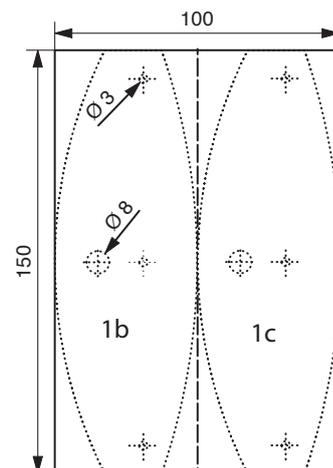
2. Das Leimholz (1) zur Hand nehmen und wie abgebildet durch Diagonalen den Mittelpunkt markieren. Am Mittelpunkt den Schraubhaken (5) einschrauben (evtl. vorstechen)..
