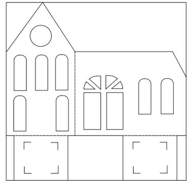
2. Ritagliare con l'archetto da traforo con lama per metallo. Per il ritaglio dei contorni interni, praticare un foro ausiliario per il passaggio della lama dell'archetto. Poi piegare secondo istruzioni di piegatura.
