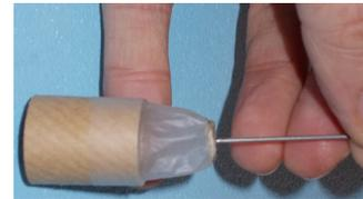
16. Posizionare la lana d'acciaio (12) sopra il pistone volumetrico e tirare delicatamente in modo uniforme. Sul sottobicchiere rimane solo ca. 1/3 (ca 11 mm in altezza) della lana d'acciaio.
