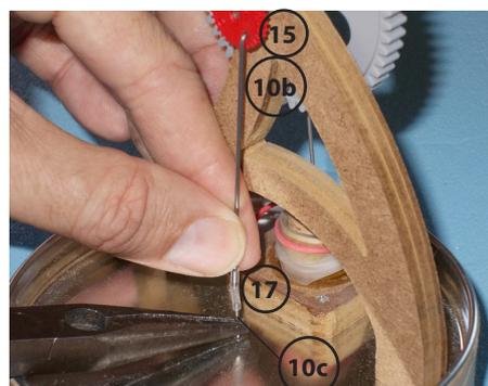
29. Après le démontage, tourner la petite roue de manivelle maintenant dans le point mort haut ; le piston de refoulement, dans cette position, ne doit toucher les vis que légèrement.
