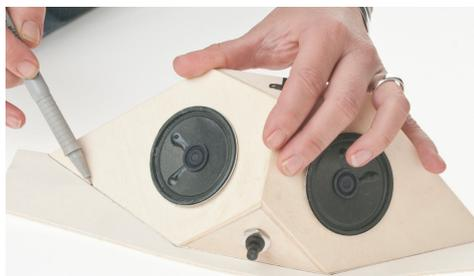
Das Gehäuse, je nach Version, auf das übrige Sperrholz (Abbildung Version "Spacig") auflegen und die Bodenplatte anzeichnen
