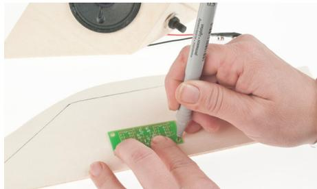
Die Platine auf die Bodenplatte auflegen und die Bohrlöcher anzeichnen. (Oberseite)
