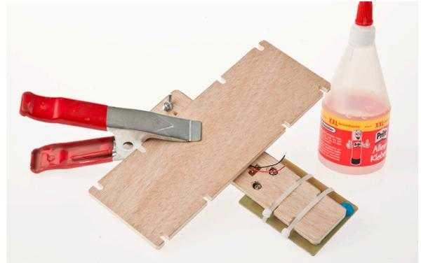
10. Collegare (torcendo o saldando) il cavo nero del motore alla connessione centrale dell'interruttore a scorrimento. Tagliare dal cavetto (9) un pezzo lungo ca. 40 mm togliere dall'estremità circa 10 mm di isolamento. Collegare il ritaglio alla connessione a destra e collegare all'ancoraggio di destra del pannello solare (vedi schema, saldare o torcere).
