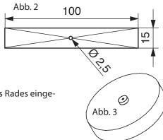
Bei der Wahl des Holzrades wird das Reduzierstück (6) in die Bohrung des Rades eingeklebt. (Abb. 3)
