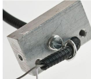
10. Vom Alu-Draht 50mm abtrennen und wie in der Abbildung bzw. der Biegeschablone biegen.
