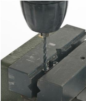
11. Die Bohrungen am Mikro-Schiebeschalter (4) auf 3mm aufbohren. (siehe Abbildung)
