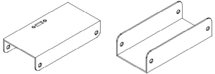
3. Alu-Rechteck (2) nach Schablone (Seite 4) ablängen. Bohrungen markieren und mit dem jeweils passenden Bohrer durchbohren!
