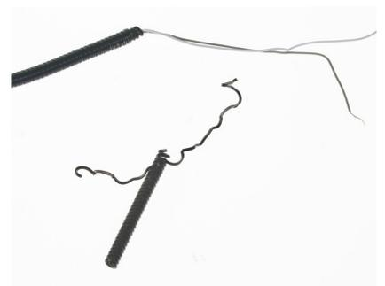
7. Die beiden Kabel ca. 10mm kürzen und abisolieren. Kabelenden verdrillen bzw. verzinnen.
