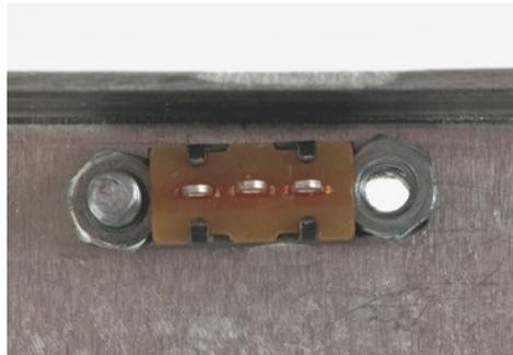
12. Den Mikro-Schiebeschalter in die Innenseite des Deckels einsetzen und wie in der Abbildung gezeigt die Mutter aufsetzen .
