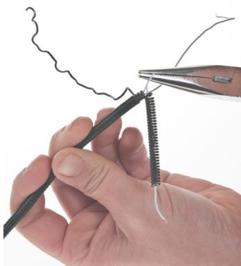
5. An der Lampe (3) die äussere Metallschicht ca. 50 mm abwickeln. Die abgewinkelte Feder mit der Biegezange umbiegen und die beiden Kabel an der durch die Biegung geöffneten Stelle herausziehen.
