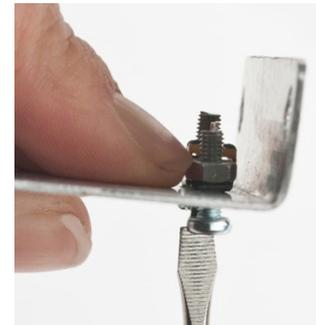
13. Die Mutter mit dem Finger fixieren und jeweils eine Zylinderkopfschraube (6) von unten vorsichtig senkrecht einschrauben und festziehen. Eventuell die Bohrungen mit einer Schlüsselfeile etwas vergrößern.
