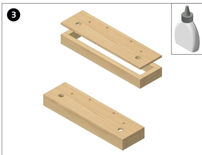
Die gebohrte Sperrholzplatte (3) auf den Rahmen aufleimen. Leim gut trocknen lassen.
