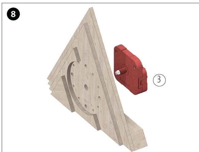
Insérer le mouvement à quartz (3) à l'arrière dans le trou central (ø10mm).
