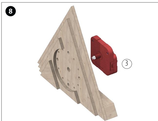
Das Quarzwerk (3) an der Rückseite in die Mittelbohrung ( $\varnothing 10\text{mm}$ ) einstecken.
