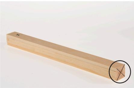
7. Encolar el segundo listón de madera (3) como tapa. En la tapa, marcar el lado al que se le encoló el trozo de listón de 20 mm, y al lado contrario, en la cara frontal, marcar el centro trazando diagonales.
