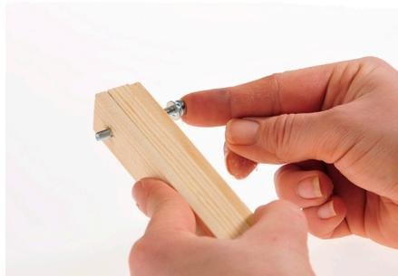
16. Colocar una arandela de separación (8) en el tornillo de cabeza cilíndrica (5) y pasar ambos por la perforación que pasa de arriba hasta abajo.
