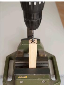
10. Fije el aparato en un banco de trabajo en posición vertical y taladre una perforación de  $\varnothing 5$  mm para la boquilla.
