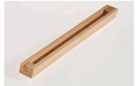
6. Encolar el segundo listón de madera (2) en el borde de los dos trozos de listón y del listón (3) (ver Figura).
