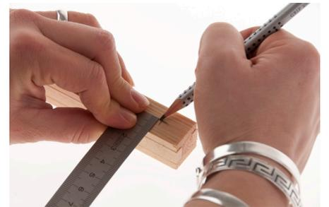
9. Marcar el centro del listón en las marcas de 15 + 50 mm, a 10 mm al interior del lado.
