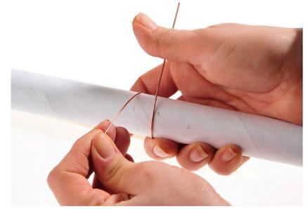
14. Enrollar el alambre de soldadura (4) bien fuerte alrededor de una varilla de madera o un tubo de cartón.
