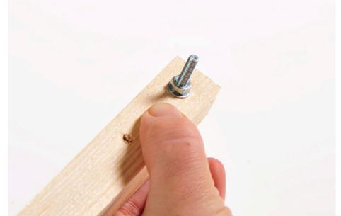
17. Colocar una arandela de separación (8) en la parte superior del tornillo y fijar la misma con una tuerca (6) (ver figura).
