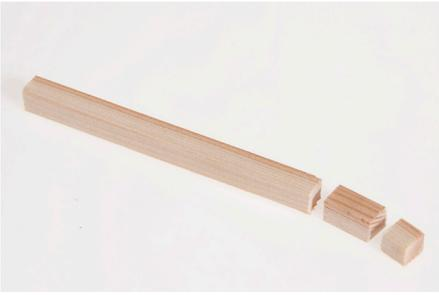
1. Del listón de madera (1), serrar una pieza de 10mm y otra de 20 mm con una sierra de marquetería (ver Figura).
