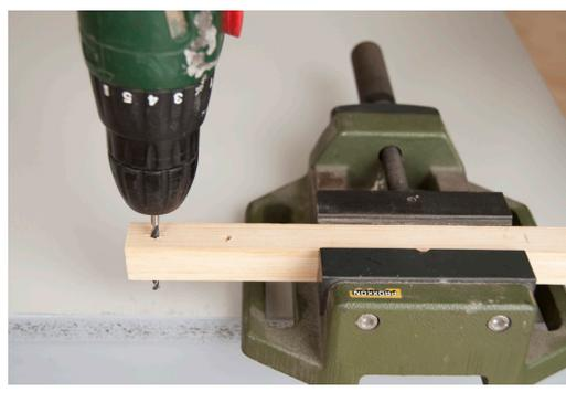
11. Ahora fijar el aparato en el banco de trabajo en posición horizontal, y realizar una perforación de  $\varnothing 4$  mm en la marca de 15 mm. Hacer la otra perforación en la marca de 50 mm sólo por la tapa.
