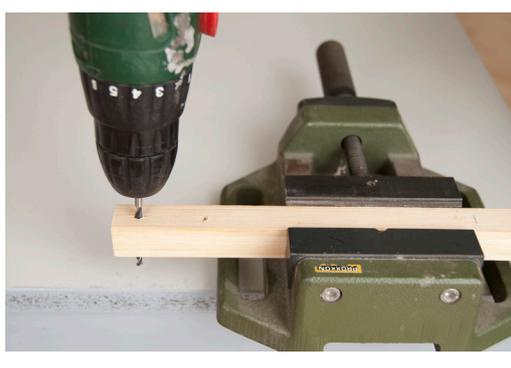
11. Fissare orizzontalmente il pezzo nella morsa. Praticare un foro tra-passante da  $\varnothing$  4 mm sulla marcatura a 15 mm. Praticare l'altro foro a 50 mm forando solo il coperchio.
