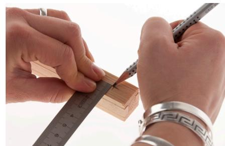
9. Con la matita riportare lateralmente una rientranza di 10 mm e segnare il centro del listello sulla marcatura di 15 + 50 mm.
