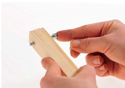
16. Inserire una rondella (8) nella vite a testa cilindrica (5) e poi inserire entrambe nel foro passante da sotto verso sopra.
