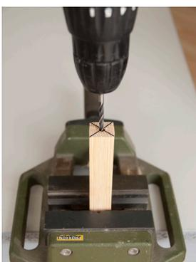
10. Fissare verticalmente il pezzo in una morsa secondo il disegno e praticare un foro da  $\varnothing$  5 mm per il bocchino.
