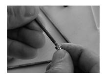
**6.** Sur 4 boules (5) percer un trou borgne au milieu de Ø 2,5mm sur env. 10-15 mm de profondeur. **Remarque:** Ne pas percer à travers!
