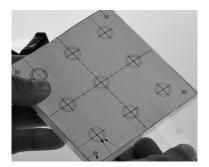
2. Fixer ce "paquet" de plaques acryliques avec des serre-joints sur un support de perçage (plaque en contreplaqué entre autres).
