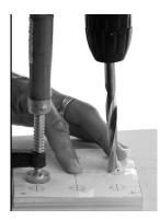
**4.** Séparer à nouveau le paquet de 3 plaques acryliques (on peut également ôter la feuille de protection). Avec un foret aléseur à 90°, chanfreiner tous les trous de 10 mm d'un côté sur env. 3 mm de profondeur (utiliser un support de perçage!).
