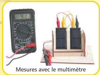
Si les cellules solaires sont connectées en series, la tension totale augmente.
