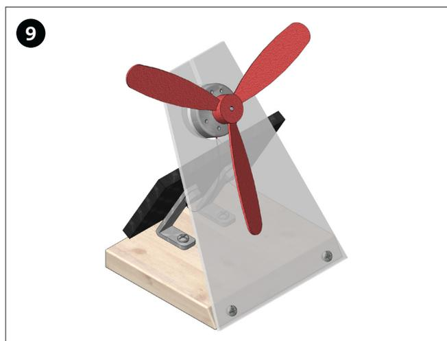
Posiziona l'elica (4) sull'asse del motore. Finito!
