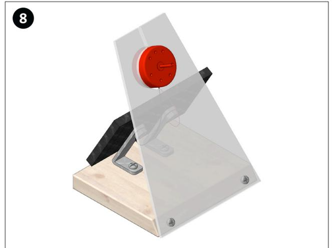
Insérez le moteur (5) dans le support pré-percé de la plaque acrylique (voir photo).
