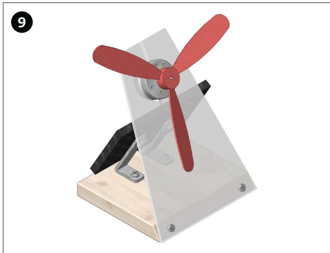
Pousser la vis à air (4) sur l'axe du moteur. Complet!
