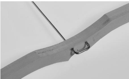
Den Zeiger nochmals aus dem Balken ziehen und an der eingedrückten Markierung ein Ø2 mm und ca. 5mm tiefes Sackloch bohren.
