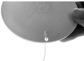
Zum Befestigen der Schalen 2 Stück mit ca. 400 mm Länge von der Kordel (Teil 16) abschneiden.
