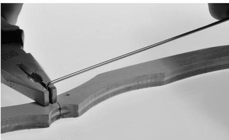
Den Zeiger an der Biegestelle mit der Zange (halbe Zangenbreite ca. 5mm) festhalten und um 90° nach unten (vorne) biegen.
