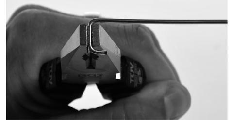
Das gebogene "U" von der Rückseite her durch die 2mm Bohrung im Balken stecken und durch Andrücken die Markierung für die Bohrung des noch benötigten Sackloches markieren.
