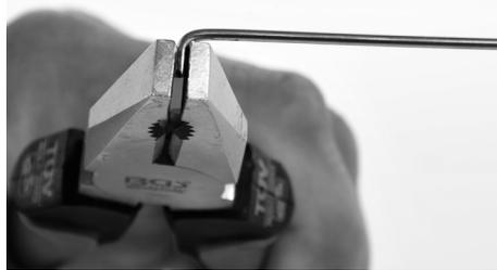
Den Draht nochmals an der 15 mm Markierung nach Abbildung 90° zu einem "U" abwinkeln.
