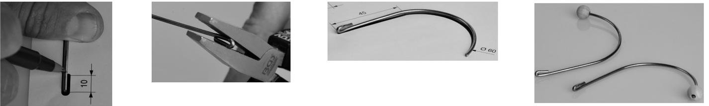
8. Cortar el tubo (12) por la mitad y colocar los trozos cortados en los extremos doblados de las antenas. Insertar las antenas, tal como se indica en la figura, en los contactos metálicos de los conmutadores.
