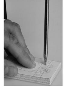
2. Recortar las plantillas para la tapa (pieza 2, pág. 7) y traspasar al contrachapado los contornos y los centros de los tornillos. Perforar los centros de los tornillos con un berbiquí o un taladro. Recortar con una sierra la silueta de la abeja y de las alas. Lijar bien todas las piezas y encolar las alas al cuerpo.
