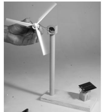
15. Inserire il cavo nella cabina e nel pilone. Cospargere i lati laterali del motore con del collante universale ed incollarlo nella cabina. Allineare il motorino nel foro e badare che non finisca del collante sull'asse.
