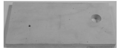
2. Collegare al retro i due fori con una piccola scanalatura di ca. 5 mm di larghezza e 3 mm di profondità (linea tratteggiata). In questo canale passano i cavetti. Il canale viene scavato con una sgorbia.
