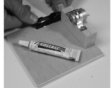
10. Bimetallhalter seitlich um 15 mm und von vorne um 20 mm eingerückt mit einer Schraube (9) befestigen.
