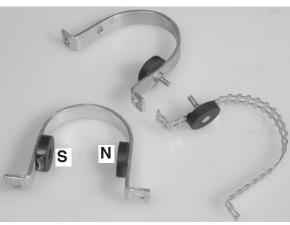
5.4.2 Infilare i supporti del rotore con gli angoli di fissaggio rivolti all'interno sull'asse e fissarli con due viti (11) in modo che l'asse possa girare senza attriti.
