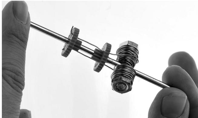
5.3.5 Selon le dessin réaliser deux contacts de frottements à partie du fil d'acier à ressort (7).
