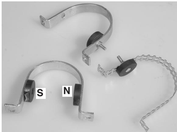
5.4.2 Faire glisser les appuis avec les brides de fixation vers l'intérieur (avant et arrière) sur l'axe et fixer avec deux vis (11) de manière à ce que l'axe puisse encore tourner légèrement.
