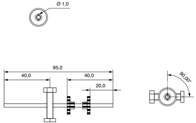
5.3.2 Selon le dessin (voir page 11), fixer la vis avec le trou (4) sur l'axe (3) Ø 3 x 95 mm, en retrait de 40 mm, avec une goutte de colle Turbo. Fixer également l'écrou à franc-bord par rapport à l'extrémité du taraud de vis, avec de la colle turbo.
