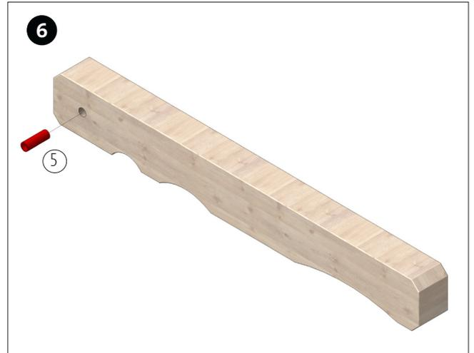
Pasar los tornillos de cabeza semi redonda (9) en las perforaciones de 2 mm. Encajar el casquillo de latón (5) en la perforación de Ø 5 mm
