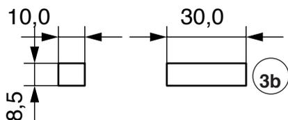
3. Raccourcir les deux lattes de pin (1) 5 x 10 x 250 mm à 200 mm de long. Ensuite, coller les lattes (1) et l'entrée d'air (3a) selon le dessin sur une latte (2) 5 x 20 x 200 mm.
