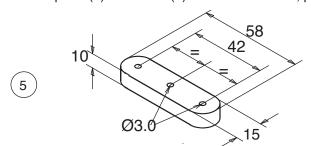
6.4.5 Inserire secondo schema un componente (1g) tra le parti (1e) e (1f) in modo che i fori si trovano in linea. Quindi infilare sulle viti (22) 3x25 mm una rondella (26) ed infilarle dal di sopra nei fori. Avvitare dal di sotto una rondella (26) e un dado (25) in modo che le parti (1g) possano girare senza attriti e gioco.
