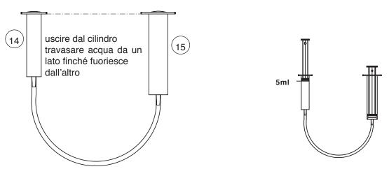
6.5.9 Incastrare secondo disegno le siringhe grandi (15) nelle mollette montate sulla barra di comando e quelle piccole (14) nelle mollette del telaio. Inserire i pistoni con i fori delle piccole siringhe nelle viti (22) del braccio e dell'asse anteriore. Bloccare con rondella (26) e dado (25).
