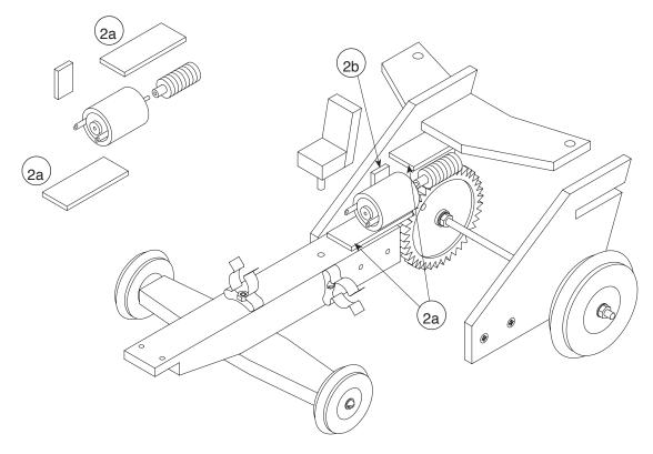
6.3.3 Incollare una seconda striscia di compensato (2a) 1,5 x 20 x 50 mm centralmente sotto l'alettone in modo da rendere invisibile la chiocciola vista dal di sopra.
