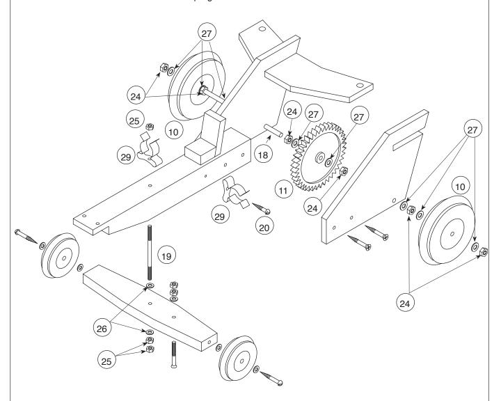
6.2.6 Inserire una rondella (27) ed inserire l'asse nel foro da 4 mm della parte laterale. Dal lato interno avvitare un dado (24), una rondella (27), la rotella dentata (11), una rondella (27) e di nuovo un dado (24). Infilare l'asse ora nella seconda parte laterale e spostare contemporaneamente la rotella dentata ed i dadi sull'asse in modo che essi si trovino centralmente tra le parti laterali. Bloccare quindi la rotella dentata tramite i due dadi.
