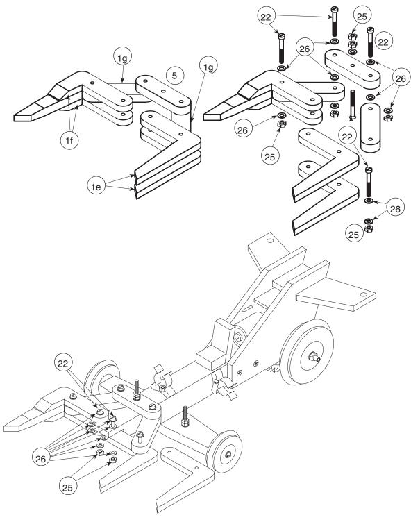
6.4.8 Incastrare il braccio al perno del lato anteriore del veicolo tra le parti (1e/1f). Per ridurre l'attrito tra le parti (1e/1f) tra il perno del telaio e le parti (1e/1f) si inseriscono ai due lati una rondella (26). Infilare su due viti (22) una rondella (26) ed infilarle dal di sopra nei fori. Avvitare dal di sotto una rondella (26) e un dado (25) in modo che le parti possano girare senza attriti e gioco.
