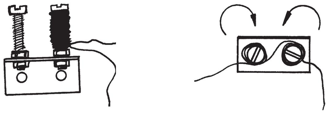
Der fertige Elektromagnet wird nach Zeichnung auf das Brettchen geschraubt. Der mechanische Aufbau der Klingel ist damit abgeschlossen.
