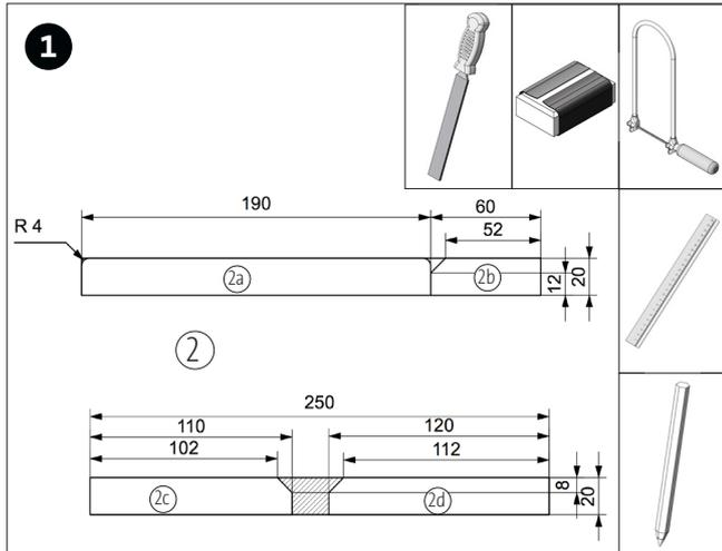
Die beiden Holzleisten (2) nach Bemaßung (siehe Seite 3) ablängen und Sägeschnitte säubern. Die Ecken der Leiste (2a) mit der Werkstattfeile abrunden.
