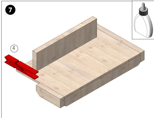
Eine Wäscheklammer (4) als Zettelhalter an der Unterseite anleimen, sodass diese nach oben ca. 20 mm übersteht (siehe Abbildung!)
