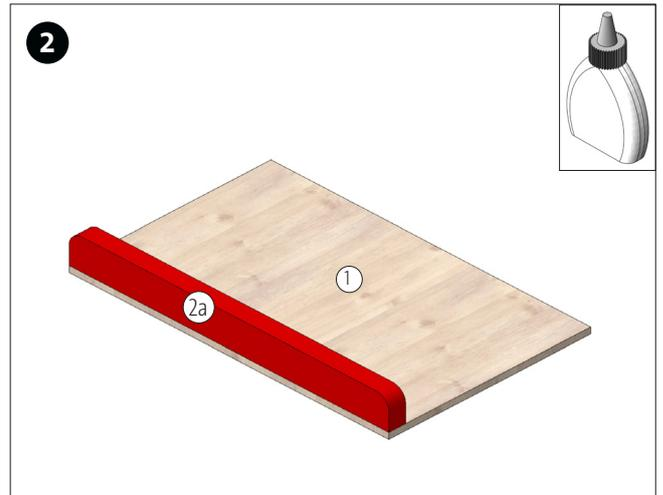
Die Leiste (2a) bündig zur Außenkante auf die Grundplatte (1) aufleimen. Leim gut trocknen lassen.
