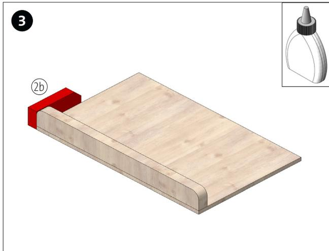
Leiste (2b) an der linken Außenseite, wie abgebildet, bündig zur Bodenkante anleimen. Leim gut trocknen lassen.
