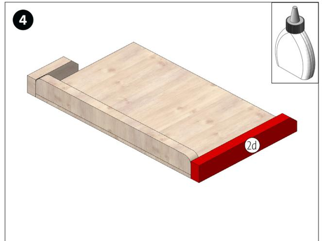
Leiste (2d) auf der rechten Außenseite bündig zur Bodenkante anleimen. Leim gut trocknen lassen.
