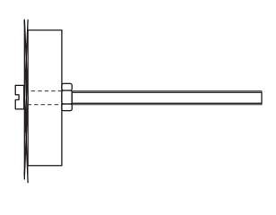
12. Pour la suite du montage, on va enfoncer une rondelle d'écartement sur la vis. Faire passer la vis à travers le palier du support et mettre, de l'autre côté, une rondelle d'écartement et un écrou. Serrer l'écrou de manière à ce que la vis tourne sans "jeu" et facilement.
