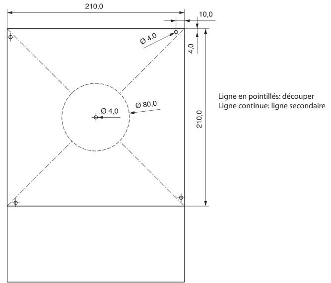
11. Plier la roue éolienne en ramenant tous les angles percés au milieu. Enfoncer par l'avant une vis à tête cylindrique M4 x 70 à travers les trous de 4mm. Enfoncer la roue en bois ø 40 mm sur la vis et, avec un écrou M4, la feuille de roue éolienne, comme illustré.
