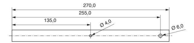
4. Enfoncer une douille 6/4 x 20 mm dans le trou de 6mm de la latte.
