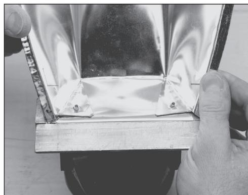
o) Le fessure nello sbalzo della prua e nelle linguette della poppa devono essere rese stagne spalmando al lato interno collante a due componenti oppure silicone oppure stagnare mediante saldatore
