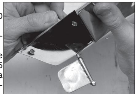
La forma piegata è più adatta per l'utilizzo concreto durante le esercitazioni in acqua. Ora possiamo montare la barra sull'asta e bloccarla provvisoriamente mediante dado a calotta (12). Quindi possiamo eseguire un primo controllo sul funzionamento del timone.
