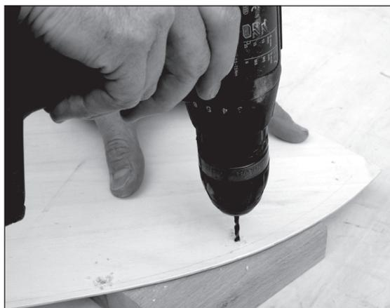
5.5.5 Eseguire il premontaggio della coperta con alcuni viti (16) e dadi M3 (17) in modo da poter controllare se i fori si trovino in linea eventualmente eseguire delle correzioni. Quindi inserire il tubetto (9a) attraverso la carena, il listello di guida fino alla coperta e tracciare questa posizione al lato inferiore della coperta.
