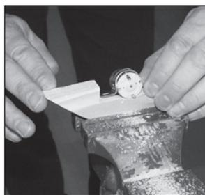
5.3.6 Fissare per controllo il supporto nella carena e montare l'asse di azionamento (8c) con raccordo (8d) sull'alberino del motore. Appoggiare l'elica marina (8f) a ca. 30 mm del tubetto Steven sull'asse che fuoriesce e controllare se l'elica non tocchi il fondo della poppa (eventualmente, se necessario, smontare il supporto del motore ed eseguire delle correzioni.)
