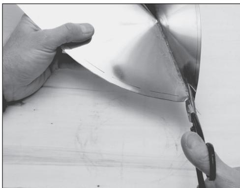
n) Piegare lo spigolo di bordatura (linea tratteggiata) di 90° mediante una pinza universale lungo tutto il perimetro. (proseguire in tre fasi: per prima a ca. 30° e poi 60° ed infine fino a 90°).
