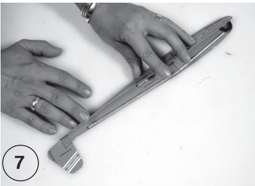
7) Enduire les surfaces marquées et les baguettes de colle et coller les deux éléments du fuselage ensemble.
