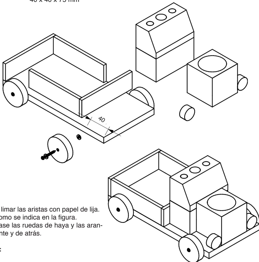
Pulir las piezas de madera y limar las aristas con papel de lija. Encolar y pegar las piezas como se indica en la figura. Atornillar en la plancha de base las ruedas de haya y las arandelas a unos 40 mm de delante y de atrás.
