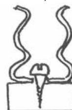
6. Lagerbock nach Zeichnung ( $\varnothing$  3 und  $\varnothing$  1,5 mm) bohren.
