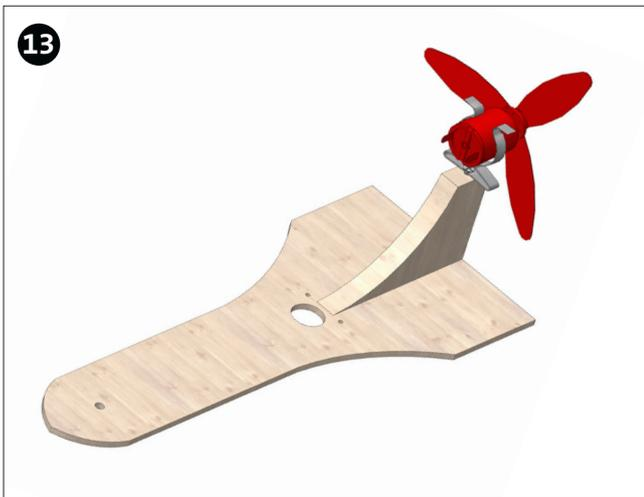
Colocar el motor con la hélice en la abrazadera.
