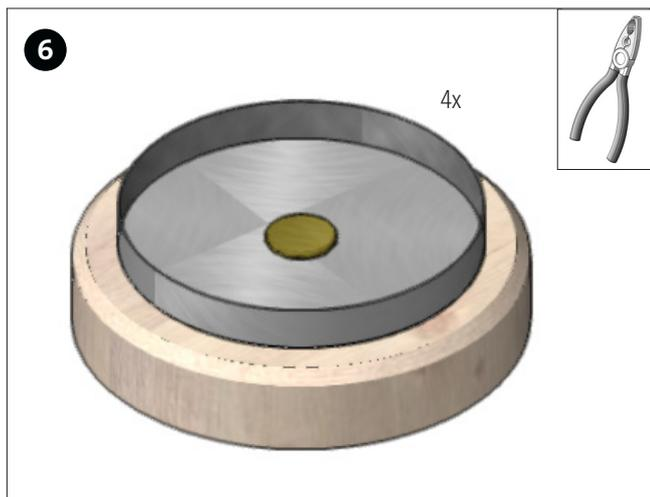
Fijar un platillo (portalamparillas - pieza 5) en cada uno de los discos de madera, utilizando una tachuela (pieza 6), tal como se ilustra.
