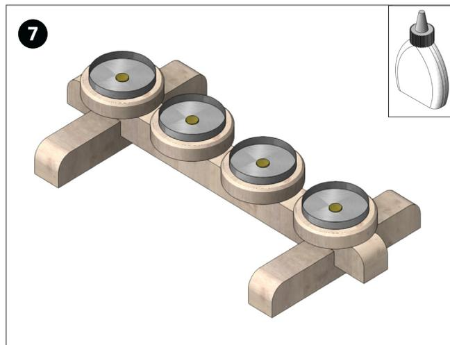
Encolar los platillos preparados en el paso 4 con cola de madera en intervalos regulares en el listón de la base.
