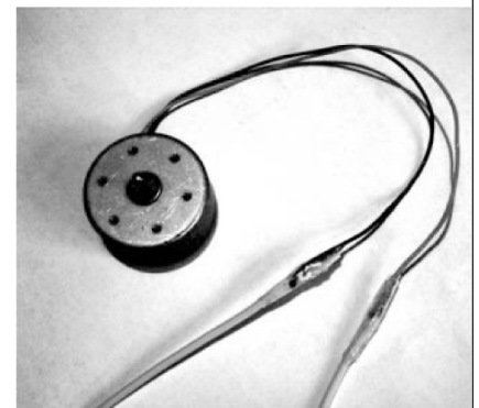
Die Verbindungsstelle Motorkabel-Krokokabel werden mit Klebeband umwickelt.
