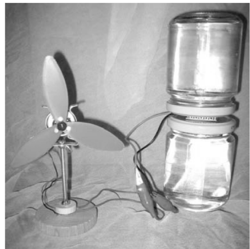
Thermokraftwerk: Oben warmes unten kaltes Wasser. Ab einem Temperaturunterschied von 15K beginnt sich der Propeller zu drehen.
