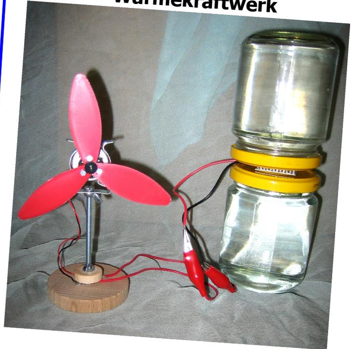
Die Energie der Wärme treibt den Lüfter an!
