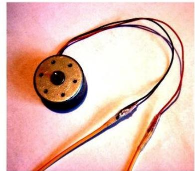
Die Verbindungsstelle Motorkabel-Krokokabel werden mit Klebeband umwickelt.
