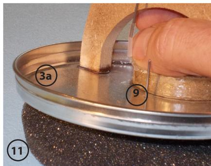
25. Ahora presionar la segunda tapa (3b) como base en el lado no ensanchado del tubo de papel rígido (17)
