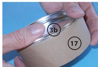
26. Colocar todo el soporte superior cuidadosamente en el tubo de papel rígido (lado ensanchado).
