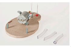
11. Dans le tube en PVC (3) couper trois morceaux d'env. 40 mm de long et les couper à une extrémité avec des ciseaux en biais à 45° env.
