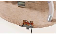
15. Couper un bout d'env. 80 mm de long dans le fil de connexion et dénuder les deux extrémités. Raccorder l'une des extrémités au raccord médian du commutateur coulissant miniature.
