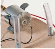
17. Relier le câble raccordé au commuta- 18. Couper un bout d'env. 40-50 mm de long dans le fil de connexion en Y (8), dénuder les extrémités et relier une extrémité avec le pôle négatif du moteur.
