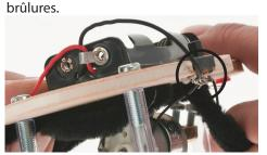
25. Faire passer le câble noir du support de pile (4) de la face supérieure vers la face inférieure et relier avec le raccord droit du commutateur coulissant miniature. Veiller à ce que les câbles entre les différents raccordements ne se touchent pas.
