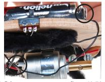
24. Découper un morceau d'env. 60-70 mm de long dans le fil de connexion (8) et dénuder les extrémités. Raccorder une extrémité au raccord encore libre du moteur (6). faire passer l'autre extrémité vers la face supérieure du support de pile (4) et raccorder au pôle négatif (à l'étrier).
