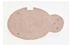
1. Reporter les contours du corps de l'araignée (Page 5). Marquer les points médians des trous avec le poinçon. Scier le corps de l'araignée à l'aide d'une scie à chantourner ou d'une scie à découper. Poncer les découpes réalisées avec du papier émeri.
