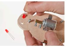
9. Pour les yeux, enfoncer les diodes lumineuses (9) à travers les trous prévus pour cela dans la tête. (voir illustration)
