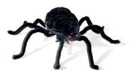
31. Selon la direction donnée aux tubes en PVC, en l'allumant, l'araignée s'avance soit tout droit, soit en cercle ou alors elle part également en arrière. ceci peut être réglé en tournant les bouts de tubes sur la vis.
