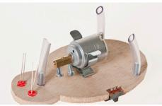
12. Comme indiqué sur l'illustration, mettre les bouts de tubes sur les vis à tête cylindrique. Si les tubes sont trop « mobiles » sur les vis et ne tiennent pas assez bien, alors enrouler auparavant un bout de ruban adhésif autour des vis.
