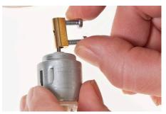
deux vis à tête cylindrique (11) sur l'axe du moteur (6), en serrant bien.
