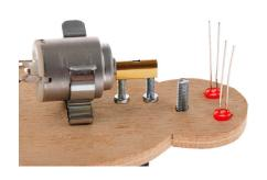
10. En mettant les diodes lumineuses, veiller à ce que les anodes (côté plus long) et les cathodes (côté plus court) soient posées en face les unes des autres. (Face aplatie vers l'arête extérieure de la tête de l'araignée).
