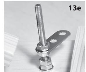
Abschließend eine Mutter (Teil 8) so aufschrauben, dass das Lenkrad (Teil 9) aufgesteckt und mit der Hutmutter M4 (Teil 10) befestigt werden kann (13f/fester Sitz).
