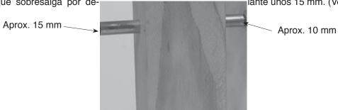
5.1.5.- Partir por la mitad el listón de madera de 10 x 20 x 150 mm para las zapatas de apoyo. A continuación perforar las piezas obtenidas (ver página 6) con Ø 3 mm y Ø 4 mm.
