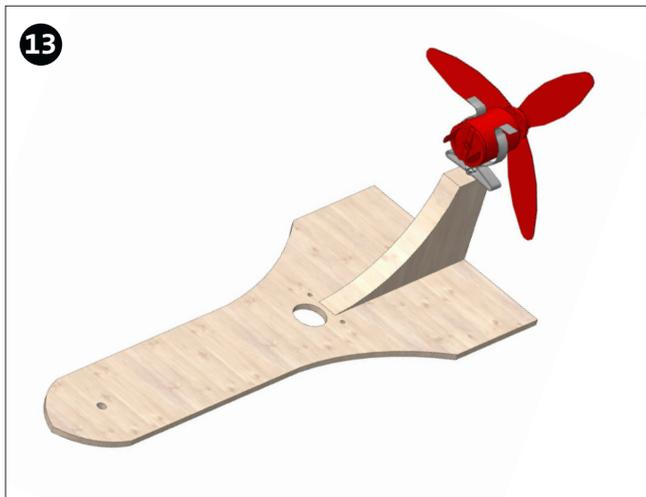
Mettre le moteur avec rotor dans la pince en acier à ressort.
