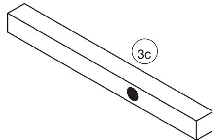
6.1.6.- Recortar un listón (4) de 5 x 15 x 150 mm. a 115 mm. (4a) y hacer una perforación de  $\varnothing 8,5$  mm. como se muestra en la figura. Limpiar el corte
