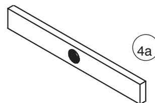
6.1.7.- De los trozos de listones (3) sacar dos piezas de (3d) de 50 mm. de longitud. Limpiar los cortes.
