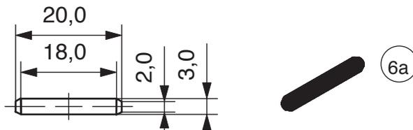
6.1.13.- Pegar a derecha e izquierda del marco un soporte con perforaciones (4b) de modo que las perforaciones de  $\varnothing 3$  mm. estén alineadas. Fijarlas con dos clavijas (6a) cada una.
