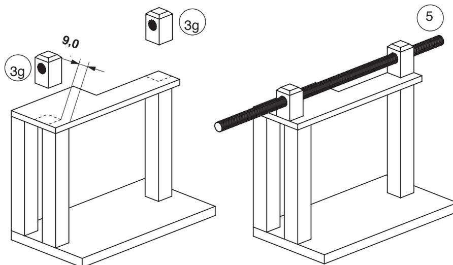
6.4.6 - Del último listón (3) se serrarán dos piezas de 80 mm. (3i) y dos de 15 mm. (3h) para el dispositivo de fijación de la transmisión horizontal. Limpiar las piezas.
