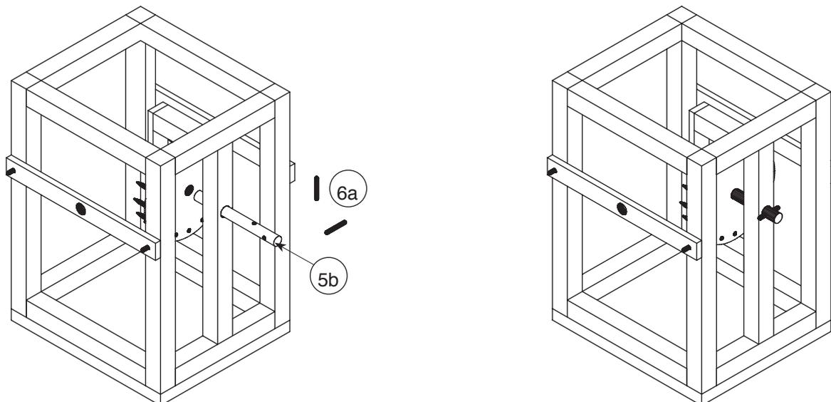
6.2.13 - Montar la rueda motriz pequeña con el árbol de transmisión (5a) en los soportes perforados. La pequeña rueda motriz engrana a su izquierda con la grande. Asegurar con dos clavijas (5a).
