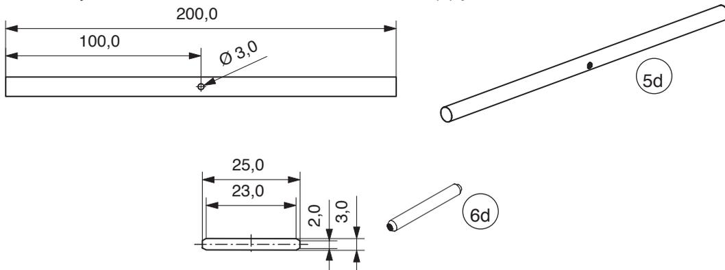
6.4.12.- Pasar la varilla (5d) en los bloques (3g) y pasar a tope la clavija (6d) en la perforación.
