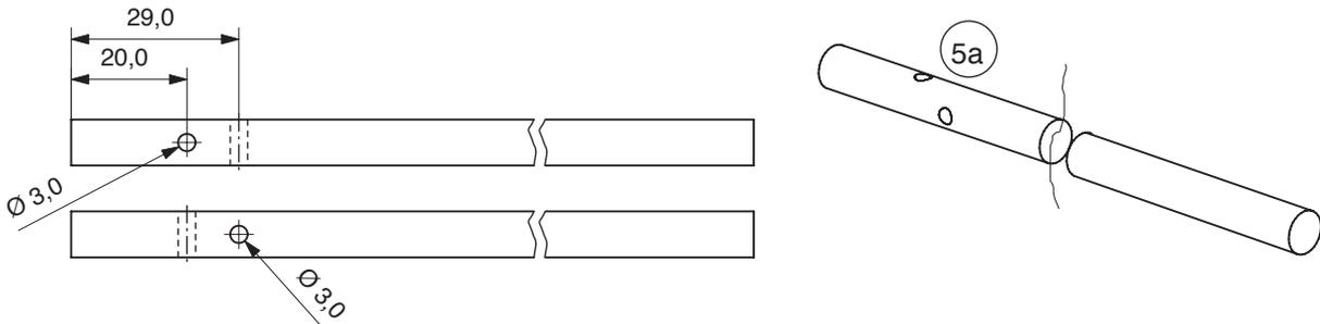
6.2.10 - De una varilla (5) de  $\varnothing 8$  x 250 mm. serrar un árbol de transmisión (5b) de 80 mm.
