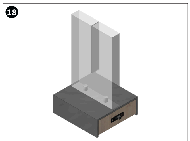
18 Plaats de batterij terug en zet deze, indien nodig, aan de binnenkant vast met een strook dubbelzijdig plakband. Klaar!
